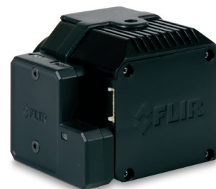
Vue Pro Rにオプションの電源/HDMI映像モジュールを追加したものの
