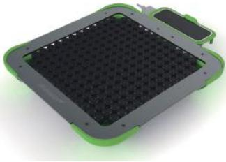
UHDK5 はハードウェア、ソフトウェア開発キット、触感エディタを含むオールインワンの評価キット。仮想ボタン・スイッチ等の簡単なユーザーインターフェースはこれ 1 台で実現可能です。安価なため、本技術の導入を検討している方へのエントリーモデルとしてもお使いいただけます。24x8 のアレイやカバーセット等、オプションも充実。
